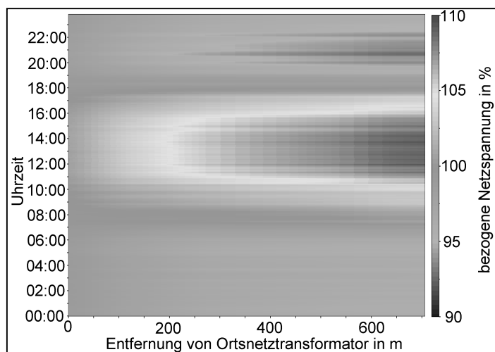
Abb. 1: Verlauf der Netzspannung an einem ca. 700 m langen Netzstrahl im ländlichen Netz bei Einspeisung durch PV-Anlagen mit 4 kW je Hausanschluß
